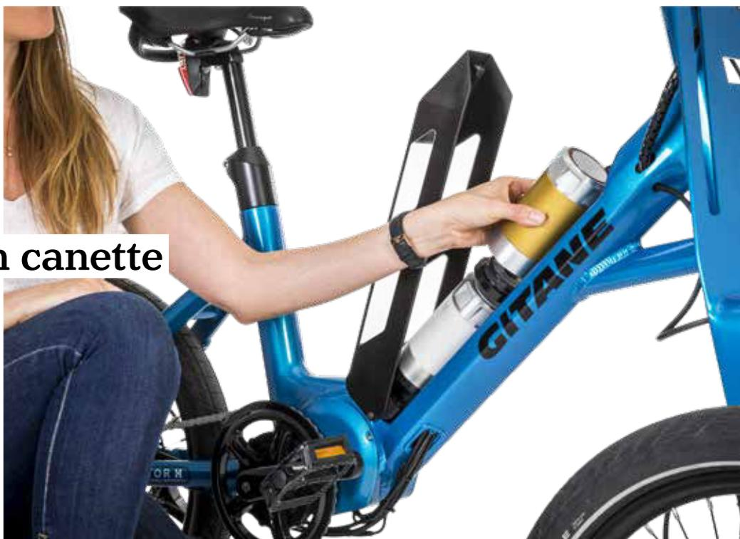
Stor-H a développé un standard de stockage d'hydrogène vert sous forme de cartouche plug and play. Une solution unique en son genre pour une mobilité décarbonée et sans batterie.
